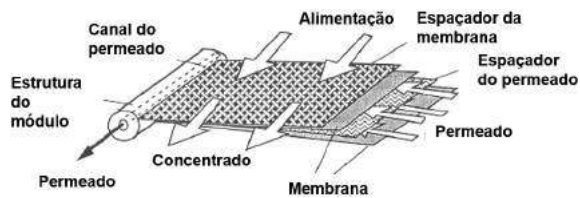
Figura 15.8 Membrana enrolada em espiral
